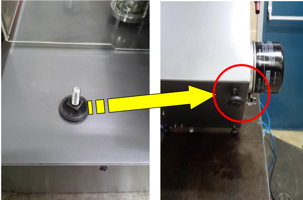
Rys. 3.2 Nóżki do poziomowania
